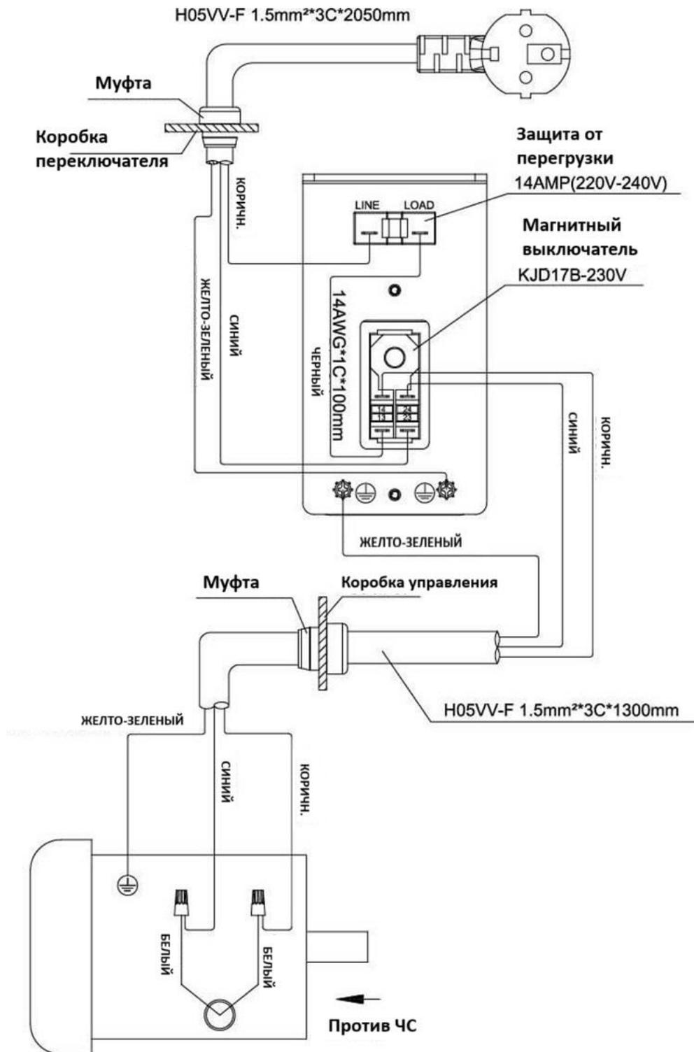
12.1 Схема электроподключения JPS-10CS-T (400V)
